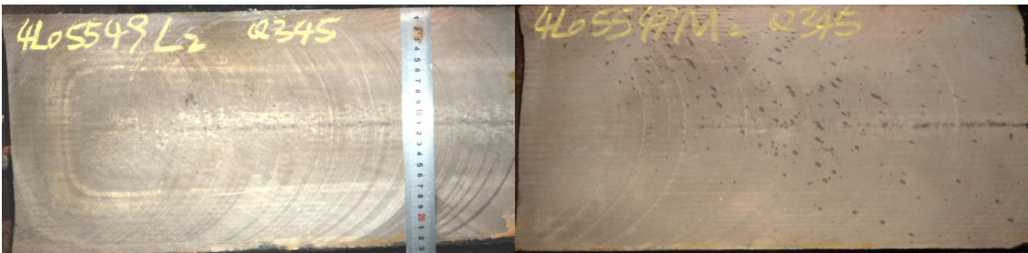
图 6 Q345B 第八炉双流低倍样(左 L 流,右 M 流)
